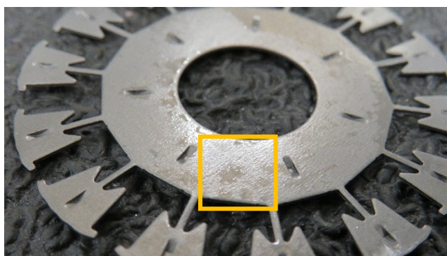
Slika 5: Nečistoče (detajl) na površini lamele
