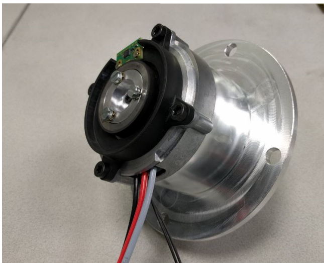
Slika 4: Izdelan prototip motorja. Prikazana je zadnja stran motorja, kjer je nameščen radialni enkoder. Na prednji strani motorja je vidna obrobnica za vpetje motorja s prenosnikom.
