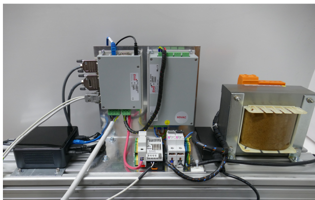
Slika 6: Izvedba krmilnika IPC (levo) in krmilnika Elmo (na sredi). Ob krmilniku Elmo se na desni nahaja enosmerni napajalnik z napetostjo 60Vdc in enofazni transformator iz omrežja na napetost 60Vac.
