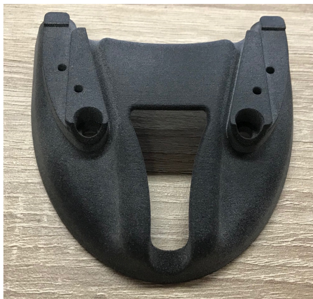
Slika 6: Ohišje natisnjeno z HP MJF tehnologijo 3D tiskanja
