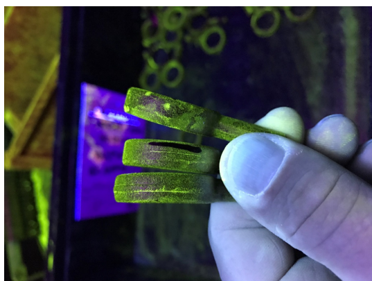
Slika 1: Napake na površini pod UV-svetlobo (vir: Marovt, d. d., Stranice, Slovenija).
