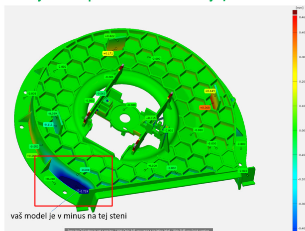
Slika 8: Odstopanje po optimizaciji nasprotno oblike in skrčka
