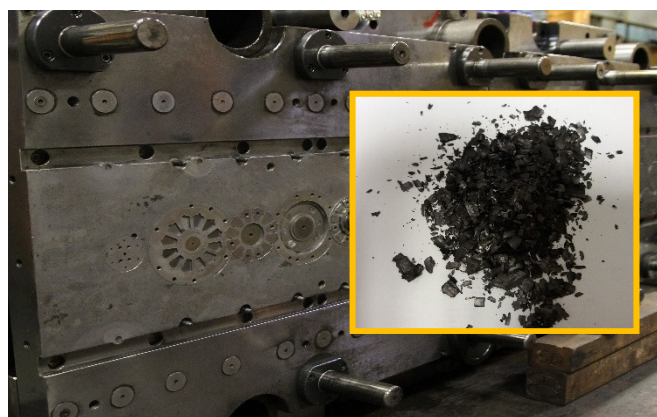
Slika 2: Primer štančnega orodja in kontaktnih površin ter nečistoč na površini (detajl)
