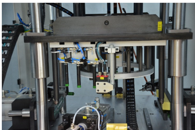
Slika 2: Vpenjalna priprava naprave za testiranje tesnosti
