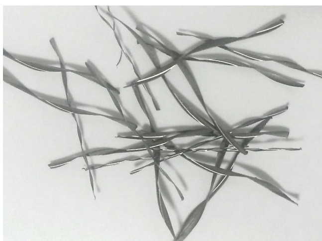
Slika 2. Odrezki, nastali pri izbiri ustreznih rezalnih parametrov [6]
