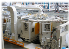
Slika 11: Stroj za vrtljivo mizo za visoko serijsko proizvodnjo.
