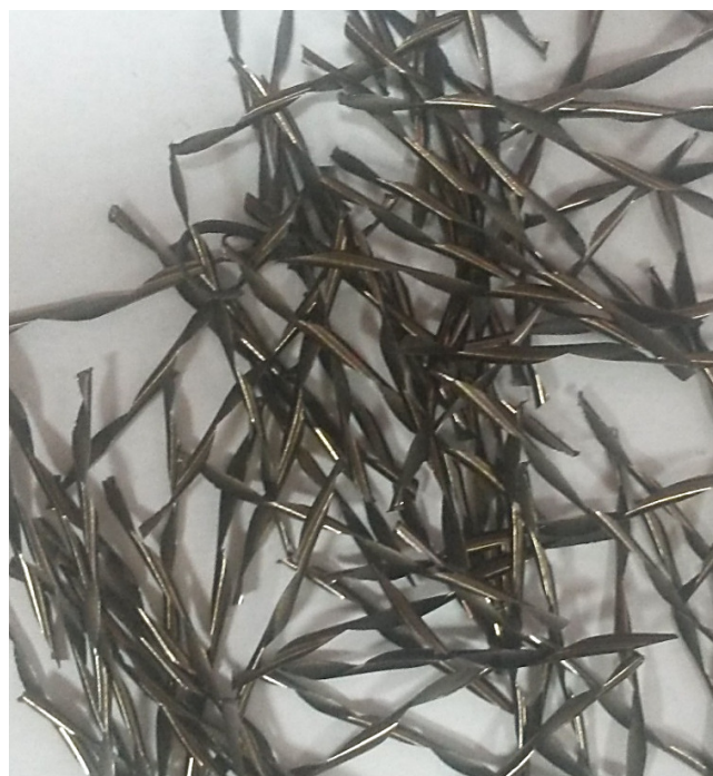
Slika 3. Odrezki, nastali pri izbiri neustreznih rezalnih parametrov [6]
