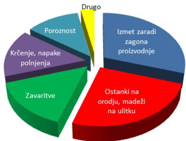
Slika 8: Statistična razdelitev napak pri tlačnem litju aluminijevih zlitin
