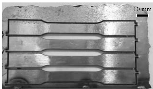
Slika 2 Izdelava standardnih preizkušancev za natezni preizkus.
