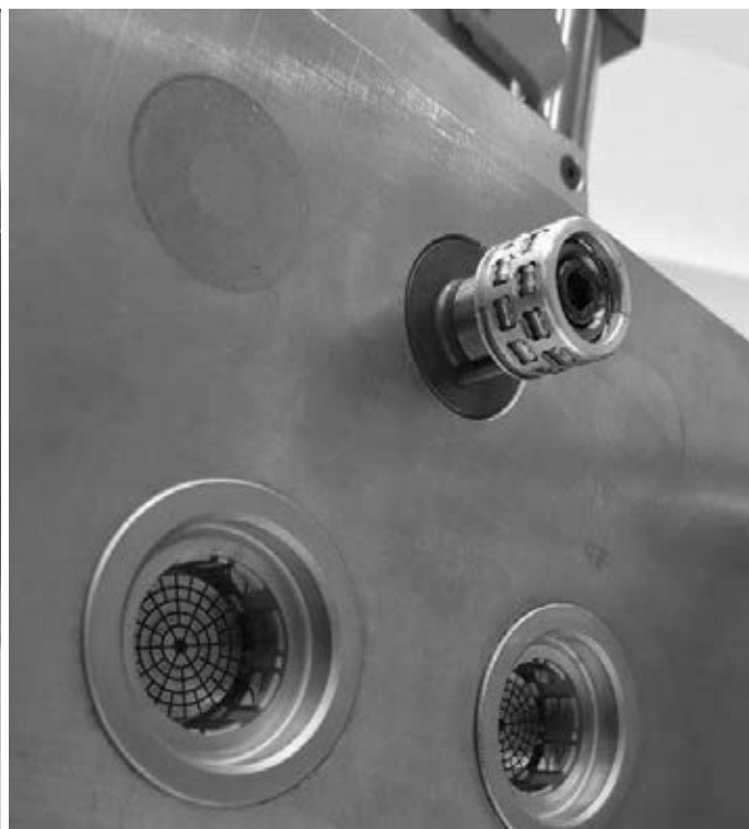
Slika 13.: Moški del z gibljivimi elementi enote za okroglo fino centriranje
