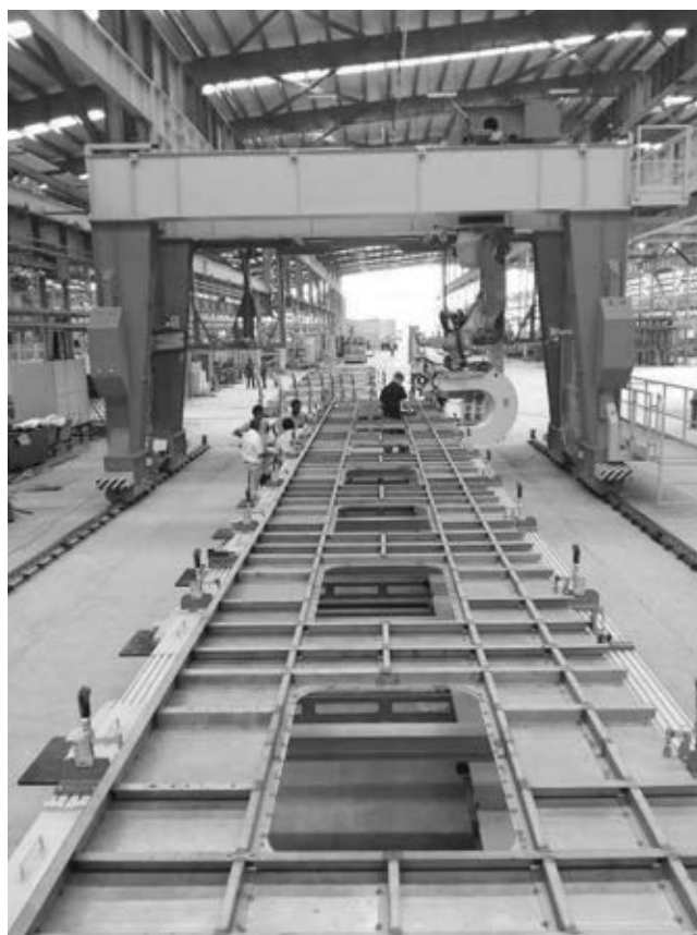
Slika 8: Varjenec (stena potniškega vagona) ter portal s KUKA manipulatorjem v ozadju
