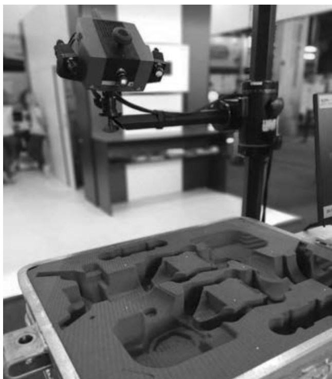
Slika 7: 3D skeniranje donjeg djela kalupa
