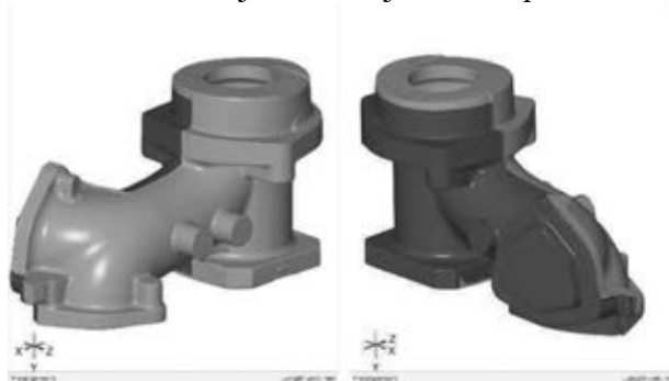
Slika 5: Local Best Fit poklapanje polovica
