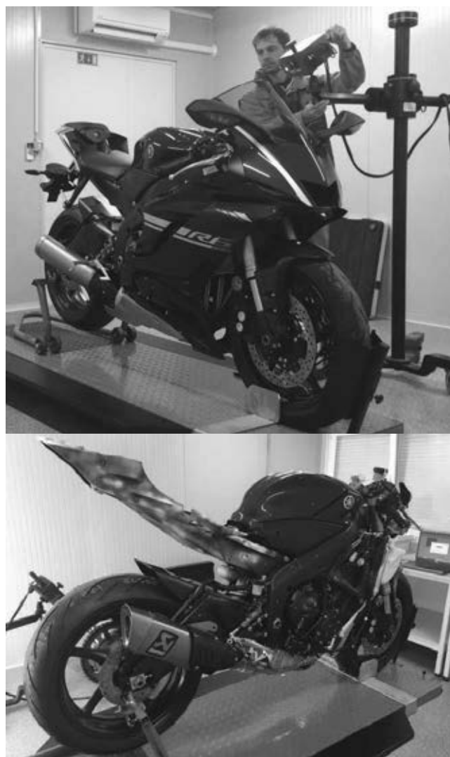
Slika 1: 3D optično skeniranje motorja [1]
