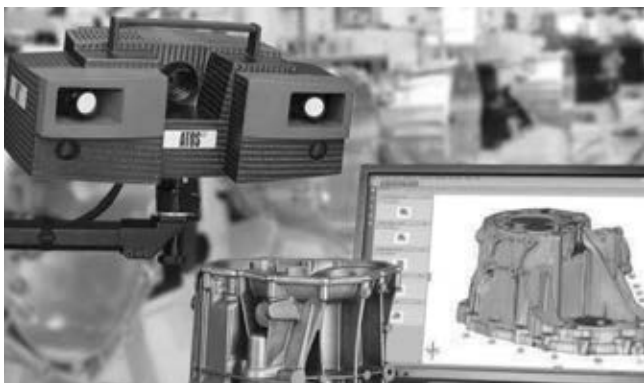
Slika 3: optični merilni sistem GOM Atos III.
