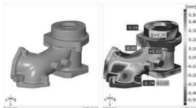
Slika 2: Rezultat 3D skeniranja (lijevo) Odstupanje prikazano u mapi boja (desno)
