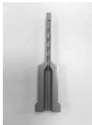
Slika 1: Jedro orodja s konformnim hlajenjem za brizganje plastičnih komponent.
