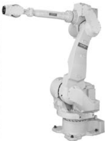
Slika 8: varilni robot tipa FD – V6 z nameščeno varilno opremo »Synchrofeed«
