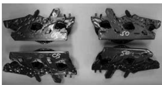
Slika 6: Analiza polnjenja gnezd – delni brizg
