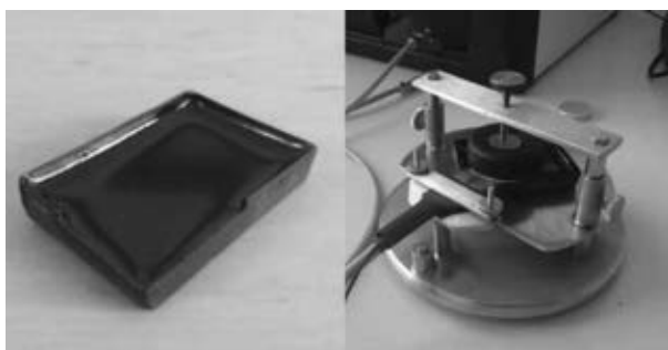
Slika 2: Primer kokile z emajlom (levo), postavitev senzorja (desno)
