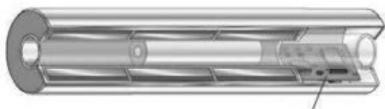
Slika 9: Primer izvedbe DC LVDT senzorja, na skrajni desni strani se vidi signalno vezje
