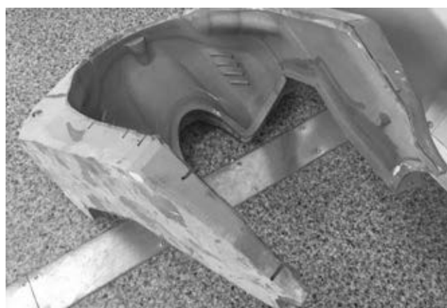
Slika 5: Trodelni kalup orodja za oklep okoli tanka [2]
