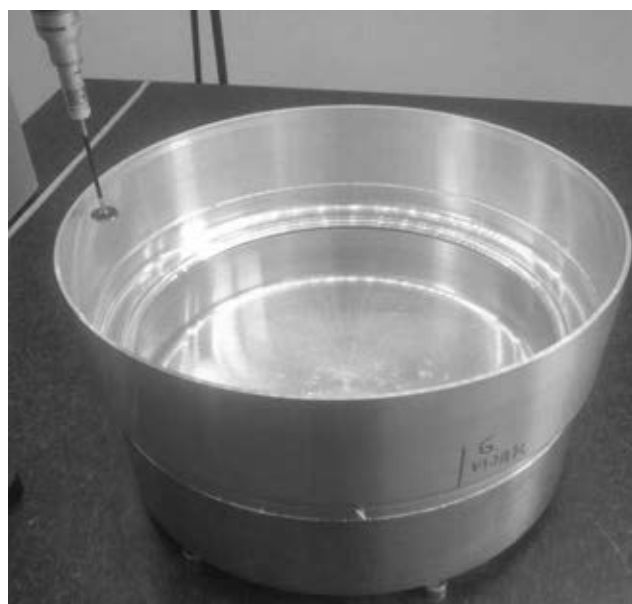
Slika 8: Meritev cilindričnosti ohišja rotorja v pripravi
