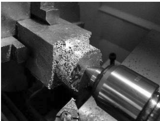
Slika 1: Struženje polizdelka iz aluminijaste pene
