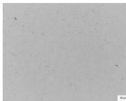
Slika 4 Mikrostruktura po optimizaciji procesnih parametrov brez plinske poroznosti.
