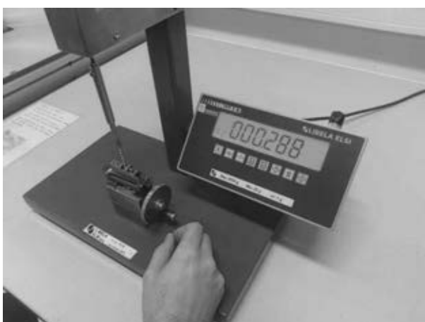
Slika 6: Merilni sistem za merjenje sile magneta na enoto dolžine
