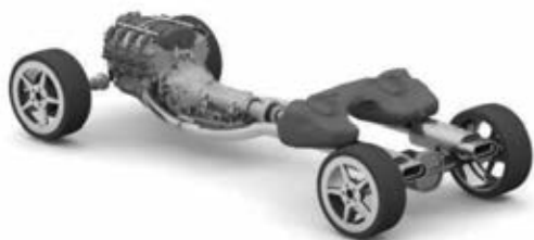
Slika 3: Štirikolesni pogonski sklop vozila z motorjem na notranje izgorevanje [3].
