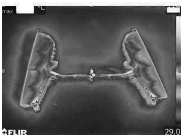
Slika 8: Meritve temperatur na izdelku s termokamero FLIR
