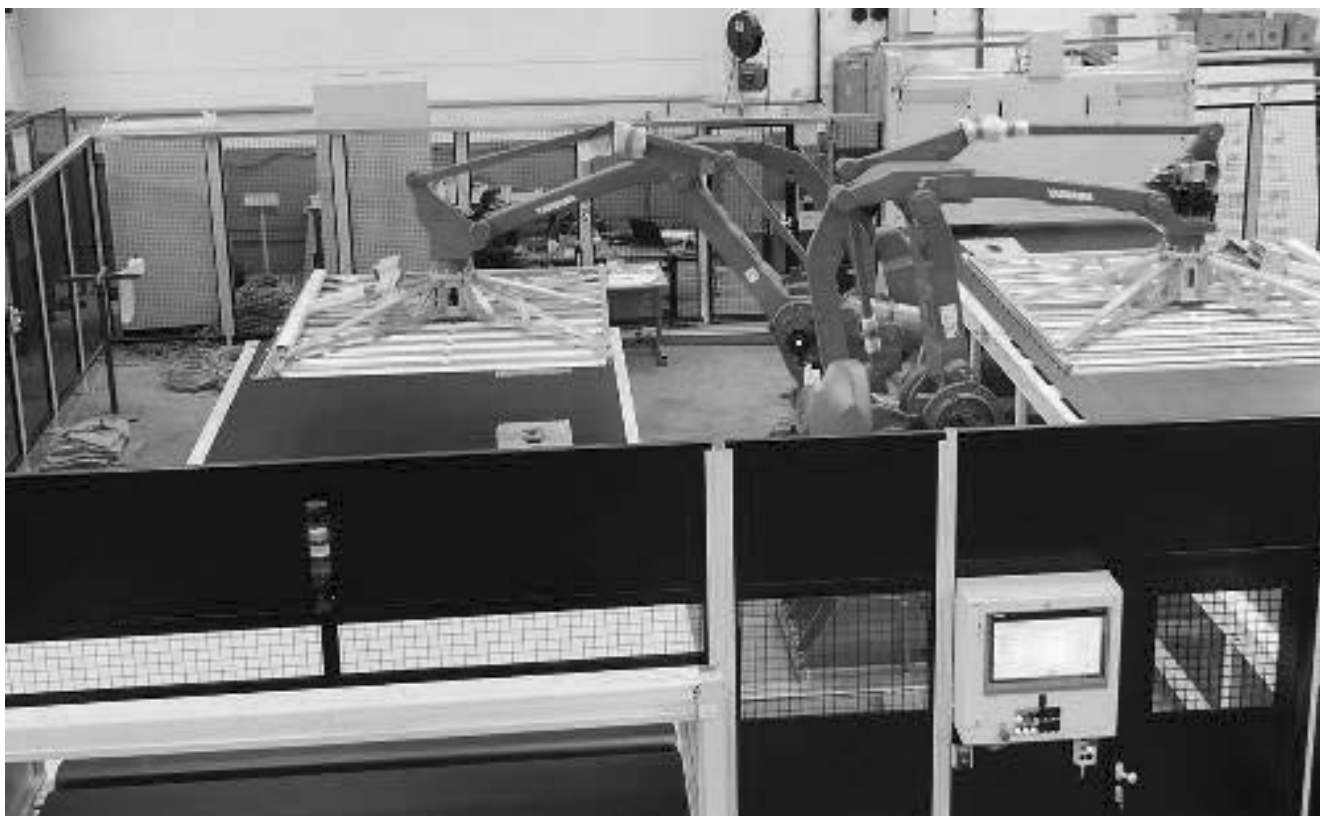
Slika 2: Robotska celica za skladanje volne
