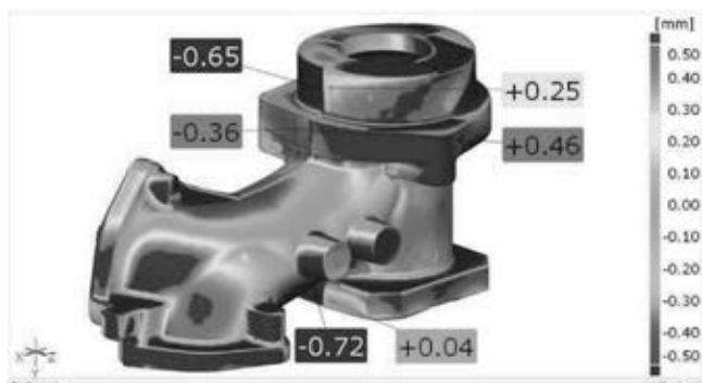
Slika 3: Odstupanje odljevka od CAD modela
