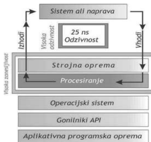
Slika 1: Princip delovanja FPGA-ja [2]
