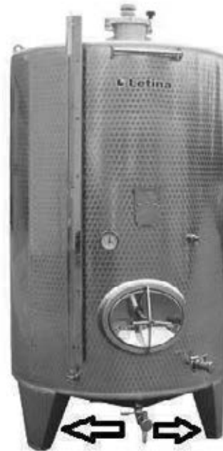
Slika 6: Rezervoar iz nerjavne pločevine – prikaz nogic za varjenje
