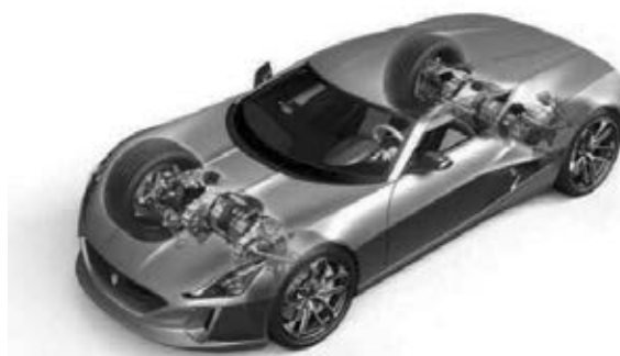
Slika 2: Rimac Concept One s štirimi motorji, po dva na prednji in zadnji osi [2].
